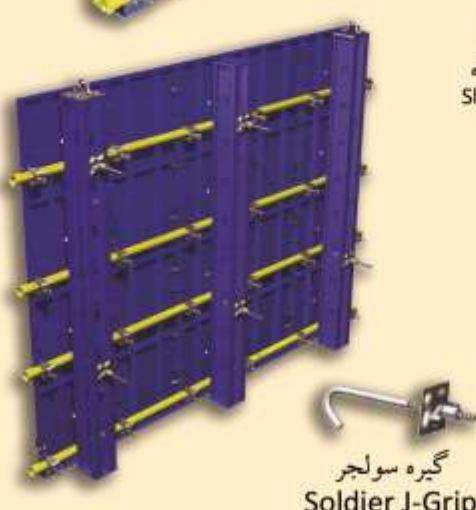
گیره سولجر (بولت عصایی) که جهت یکپارچه کردن پانلها و حمل جرثقیل به کار میرود. بولت عصایی لوله پشت بند افقی را (که خود توسط گیره کوتاه به قالب متصل شده) به سولجر متصل می کند.
