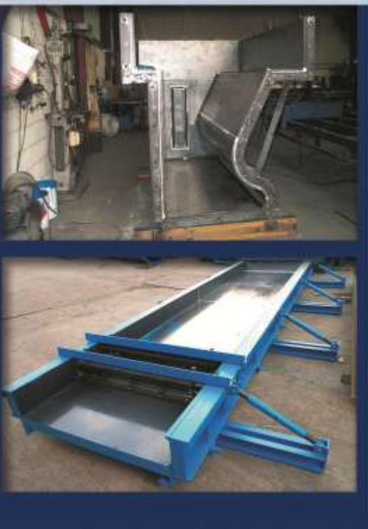
این نوع قالب ها با توجه به طرح قطعه پیش ساخته ، طراحی و ساخته می شوند مانند قالب تیرهای پیش ساخته ، جدول ، نیوچرنسی ، قطعات پیش ساخته منهول و لوله سیمانی، موج شکن و ... از قالب قطعات پیش ساخته به تعداد دفعات زیاد استفاده می شود. در نتیجه در طراحی این نوع قالب ها باید ضربت تکرار و شرایط بتن ریزی و حمل در نظر گرفته شود. تعدادی از مهمترین قالب های اتصالات پیش ساخته عبارتند از:
