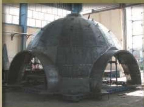
از آنجا که گنبد دارای قوس در دو جهت می باشد، برای ساخت قالب آن می بایست در جهت قائم ورق ورق قالب ها را به شکل قوسی و در جهت افقی قوس گنبد را به صورت یک  $\pi/2$  ضلعی اجرا کرد که برای این کار می بایست قالب ها را در کارخانه و در حال مونتاژ ساخت و پس از جوش دادن تسمه ها، قالب ها را باز و به محل پروره داد.
